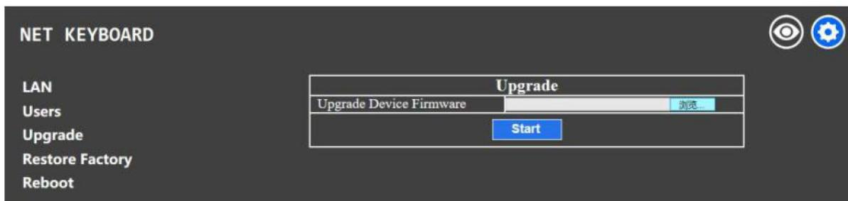
升級功能作為維護與更新鍵盤功能使用，進入升級頁面後選擇正確的升級檔，點擊「開始」即可，升級完成後設備將會自動重開機。
